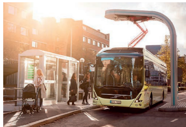
Slika 3.1.11. Primjer stanica za brzo punjenje na kraju autobuske linije
