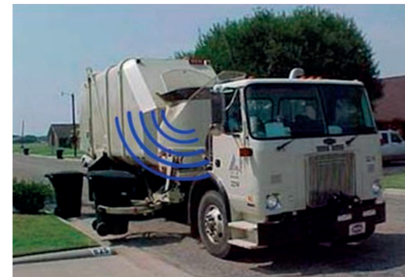
Slika 3.2.4. Očitavanje RFID oznake kontejnera
