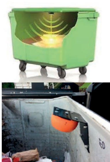
Slika 3.2.2. Primjeri senzora u kontejnerima za otpad
